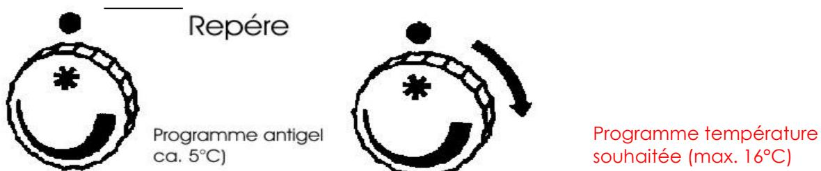
**Réglage de la température souhaitée:** Tournez le bouton dans le sens de la flèche vers la droite jusqu'à ce qu'il s'arrête (ca.  $\angle 90^\circ$ ) et jusqu'à ce que l'appareil antigel ait chauffé la pièce à la température souhaitée. Tournez ensuite lentement le bouton vers sa position initiale jusqu'à ce que la lampe de contrôle s'éteigne. La position du bouton tournant correspond à la contrôle voulue.
